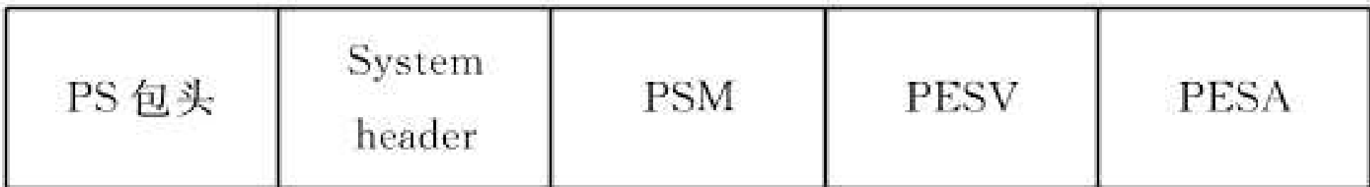
图 C.1 典型的视频关键帧 PS 包结构
